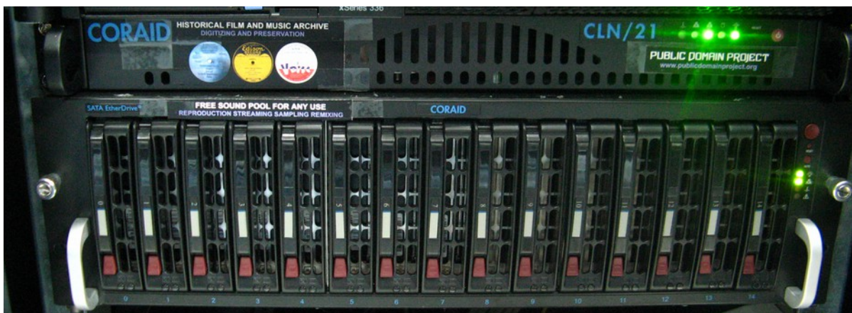
Abbildung 10: Coraid SR1521 Disc shelf und CLN/21 Storage controller
